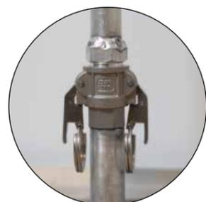
El manillar se fija mediante un cierre rápido.
