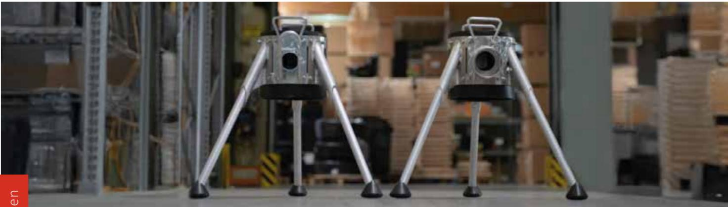
Unser 3-Bein Auslaufbock überzeugt vor allem durch Robustheit und Langlebigkeit. Alle Teile sind geschraubt und können dadurch ganz einfach ausgetauscht werden.
